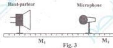
Le signal sonore capté par le microphone est transformé en une tension électrique  $u_M(t)$ .
